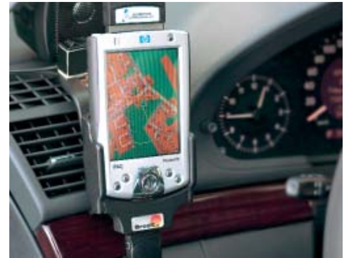
Vantaalaisen Voxpointin taksijärjestelmä sopii pienillekin taksiyhteisöille, kuten Vihdin 25 autolle. Näyttönä on kämmentietokone, jossa satelliittipaikannus näyttää määränpään ja auton kartalla. Tilaispuheluihin vastataan valvomossa Varkaudessa, jossa on opiskeltu myös Vihdin ravintoloiden, terveyskeskusten ja muiden avainkohteiden sijainti siinä kuin Joensuun, Nilsin ja Varkaudenkin.
