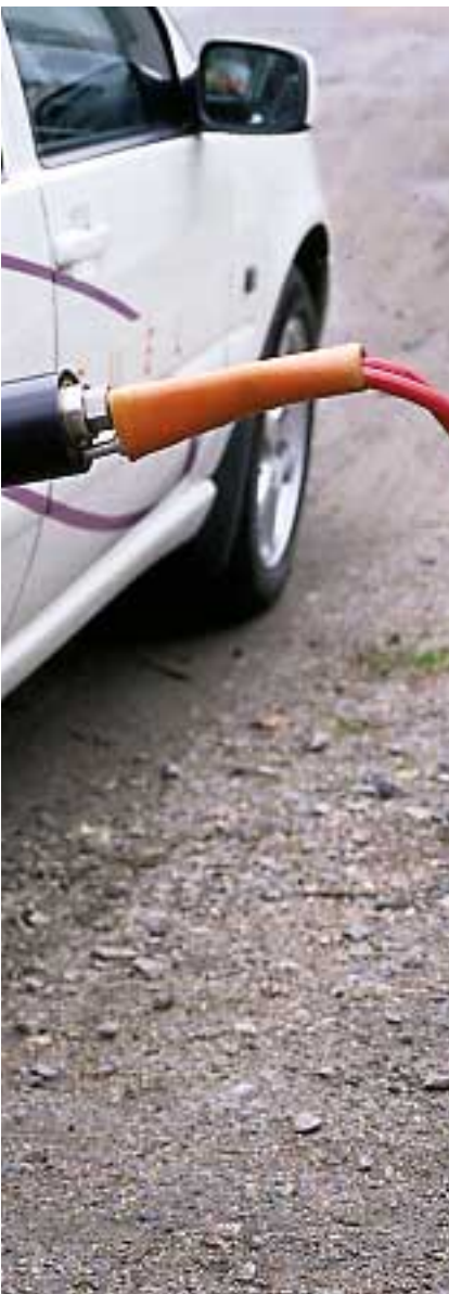
▲ POSTIN upouuden Mercedes-Benz NGT Sprinter -pakettiauton kaasusäiliöt vetävät 32 m 3 maakaasua. Se riittää 150–200 kilometrin jakeluajoon.
