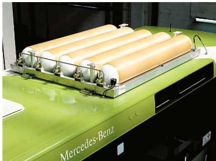
▼ LINJA-AUTOISSA kaasusäiliöt on tyypillisesti sijoitettu katolle. Kuvassa Mercedes-Benz O 405 CNG:n komposiittivahvisteiset terässäiliöt.
