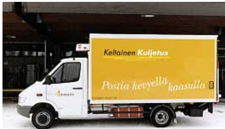
▲ POSTIN upouuden Mercedes-Benz NGT Sprinter -pakettiauton kaasusäiliöt vetävät 32 m 3 maakaasua. Se riittää 150–200 kilometrin jakeluajoon.
