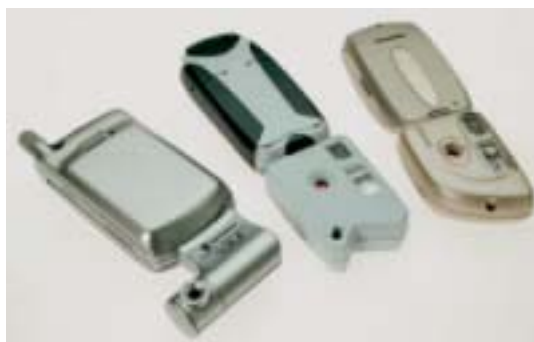
MOTOROLA T720i, Siemens M55 ja Siemens SL55 muuttuvat kamerapuhelimeksi erillisillä puhelimen pohjaliittimen työntävällä yksiköllä. Siemensen kameroihin kuuluu jopa salama.
