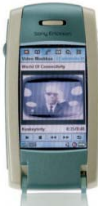
WAP-palvelut ovat saamassa ihan uutta potkua värikkäiden linkkien ansiosta. Siirtyminen eri toimintoihin käy näppärästi puhelimen keskellä olevaa viisisuuntaista, joystick-tyyppistä monitoimiohjainta kääntelemällä ja painelemalla.
