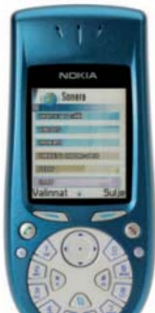
WAP-palvelut ovat saamassa ihan uutta potkua värikkäiden linkkien ansiosta. Siirtyminen eri toimintoihin käy näppärästi puhelimen keskellä olevaa viisisuuntaista, joystick-tyyppistä monitoimiohjainta kääntelemällä ja painelemalla.
