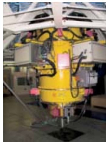
TAVALLISTA suurempi digikamera. Kuvan keltainen mötkkä on VLT:n ensimmäinen instrumentti, saksalainen FORS1, joka on saanut sittemmin seuraa myös FORS2:sta. Kyseessä on tehokas ja laadukas CCD-kamera, jota voidaan käyttää myös spektrografiaa.
