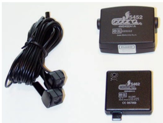
Kuvassa kolme eri tunnistintyyppiä. Vasemmalla ultraääni-, ylipäätänsä asento- ja alhaalla oikealla mikroaalto-tunnistin.
