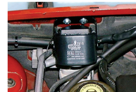
Akkuvarmennettu sireeni/hälyttimen keskuksyksikkö kiinnitettiin tulipeltiin.
